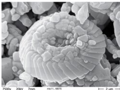
Budowa amorficzna, porowata cząsteczki kredy odmiany 06a, 07a.
